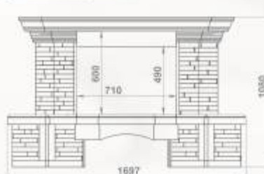
Чертеж облицовки под топку 700-й серии
