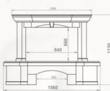
чертеж облицовки под топку 700-й и 800-й серии
